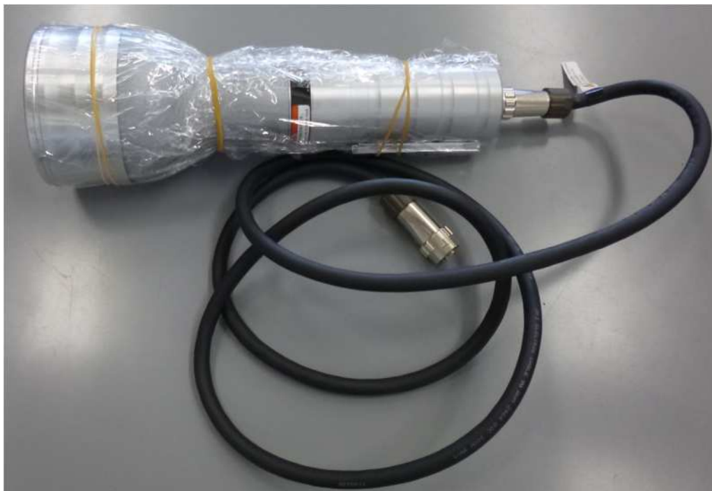
写真_3 ラップフィルムでカバーしたプローブ
