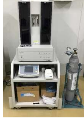
低バックグラウンド 放射能測定装置（ \beta 線） ストロンチウム90 の測定に使用
