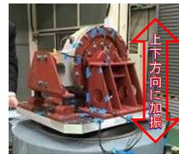
スラスト軸受加振試験
