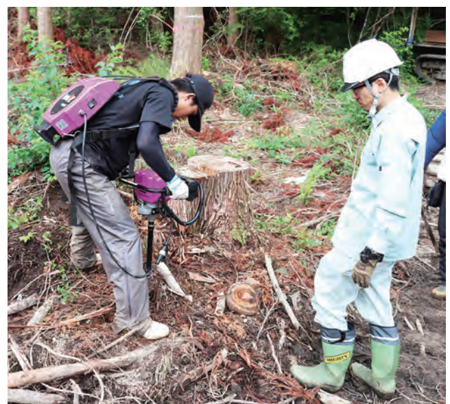
電動オーガによるコンテナ苗の植え付け穴掘りの状況
