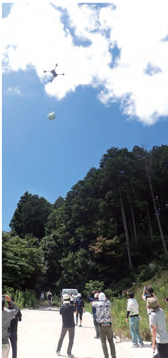
運搬ドローンが予め設定された飛行ルート（右図）に沿って自動飛行した後、荷物を降ろす様子（左写真）を見学
