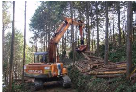
プロセッサによる造材作業（神崎市）
