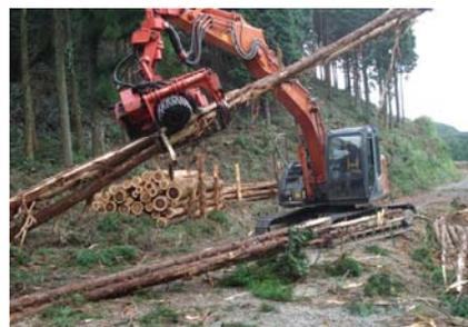
プロセッサによる造材作業
