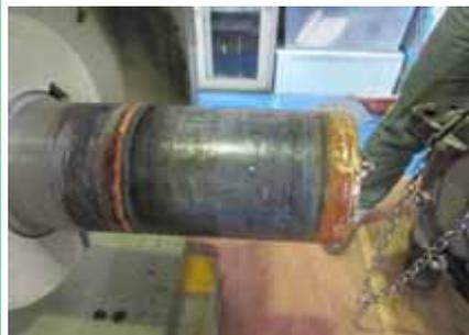
排水ポンプ（軸受部）の老朽化
