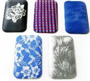
従来技術では困難とされていた、立体の曲面にも高品質な加飾を可能とする技術開発を進めています。加飾用のシートに関する技術と、高度な金型技術が、製品づくりの納期短縮に大きな貢献を果たします。
