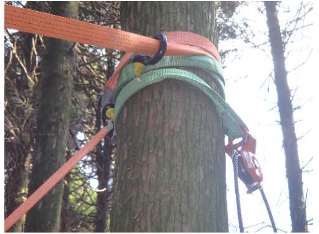
●先柱控索の軽量資材での架設実習
