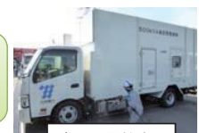
高圧発電機車
