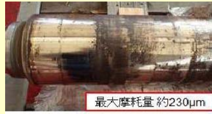
参考:H26耐久走行試験時の車軸 (標準軌走行距離:約2.5万キロ)
