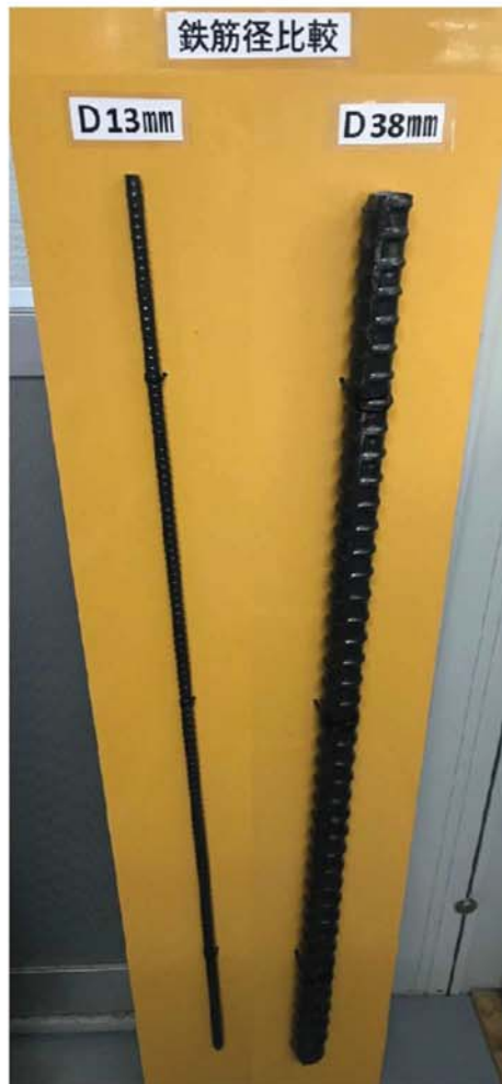
写真①：鉄筋径の比較
