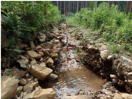
② 溪岸侵食及び不安定土砂堆積状況
