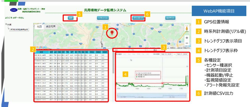
自社クラウドに実装しているWebアプリケーションへ今回の多項目水質/水圧式水位計からの計測データ監視項目を追加実装
