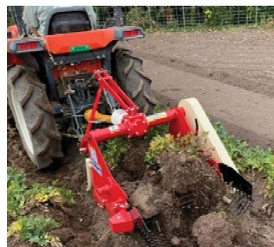
図3 トラクタ用収穫機(M社製)
