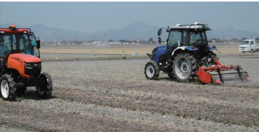
図1. 無人のロボットトラクタ(右側)と有人トラクタ(左側)による協調連携作業の様子
