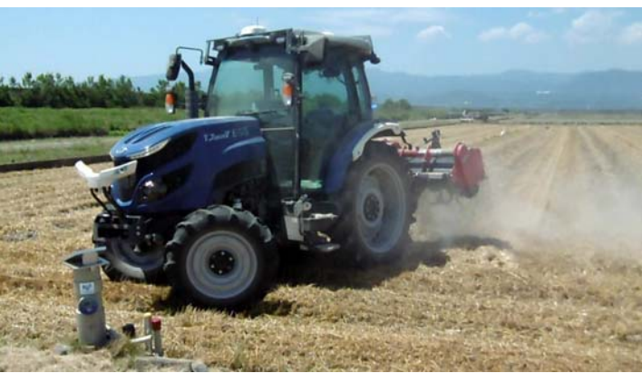
図3. ほ場水管理装置WATARAS (左下) など接触することなく、自動旋回が可能だった
