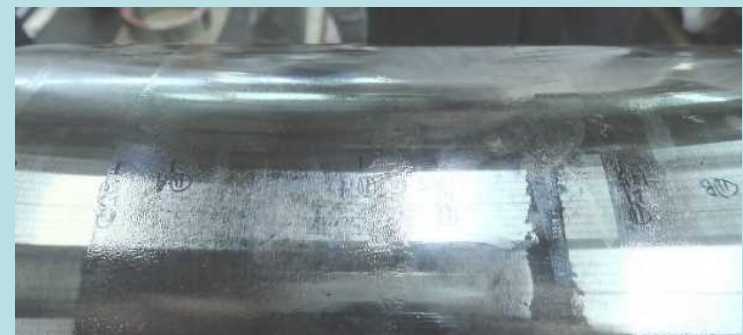
試験条件④を終えた後の車軸【走行距離: 約9,000km】
