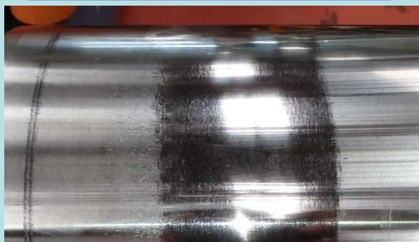
試験条件①～③を終えた後の車軸 【走行距離: 約37,500km】
