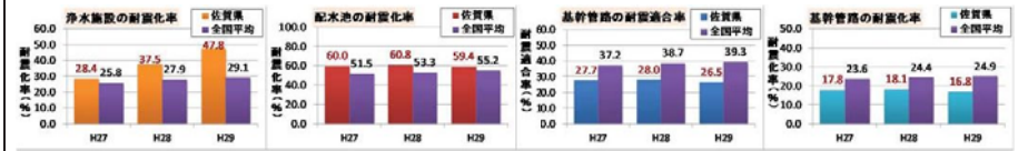
浄水施設・配水池の耐震化率、基幹管路の耐震適合率・耐震化率（上水道事業・水道用水供給事業）
