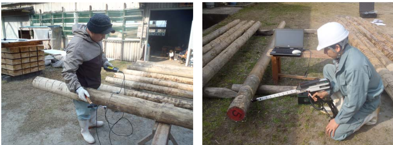
写真-1 ファコップ(左)及びデジタルマイクロプローブ(右)による測定状況
