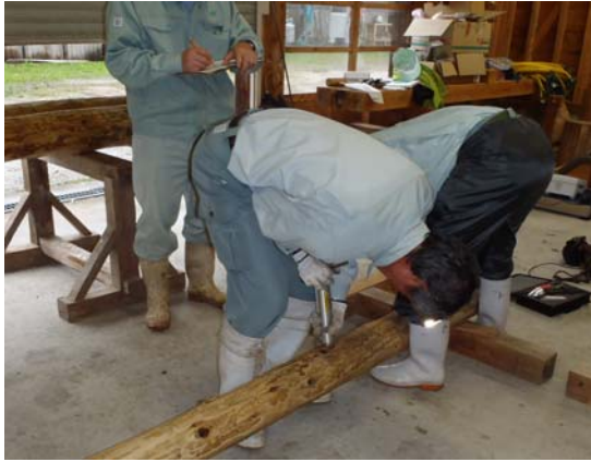
写真 - 1 ピロディン(左)及びファコップ(右)による測定状況
