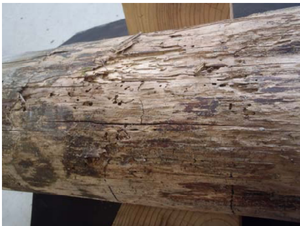
写真 - 18 虫による穿孔痕
