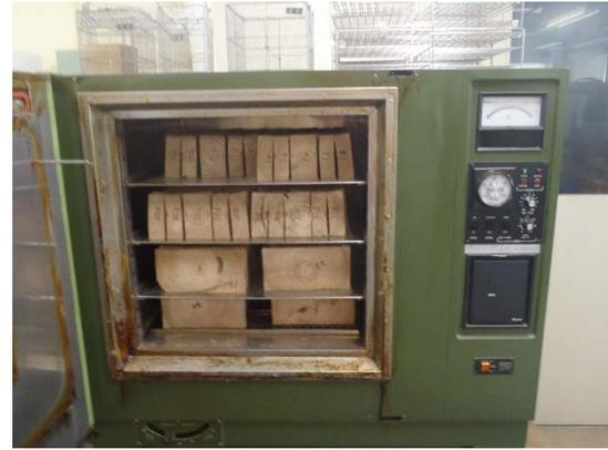
写真 - 13 乾燥機により全乾状態まで乾燥
