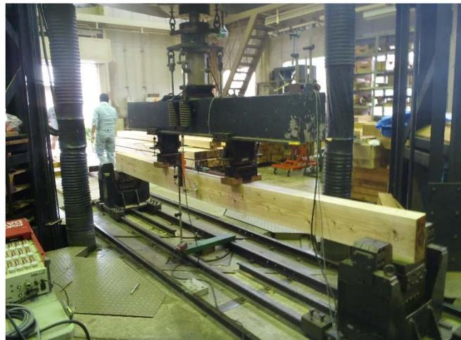
写真 - 9 実大試験機による載荷状況
