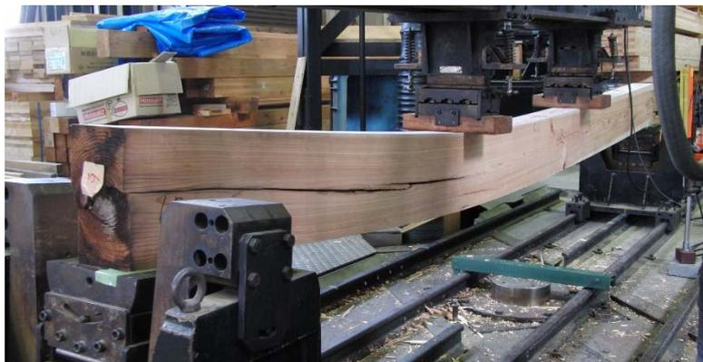
写真 - 14 せん断破壊状況
