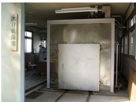
写真 - 1 高温蒸気式乾燥機
