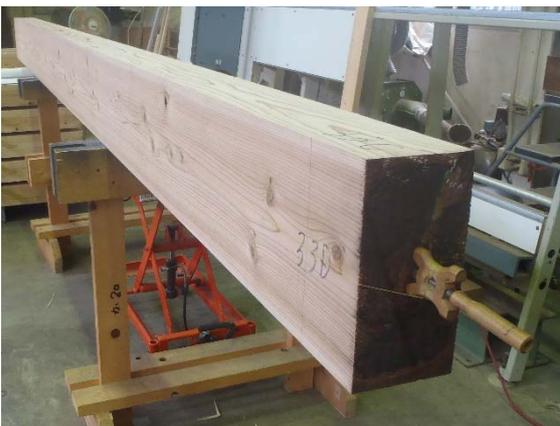
写真 - 6 水系で材面の曲がりを調査
