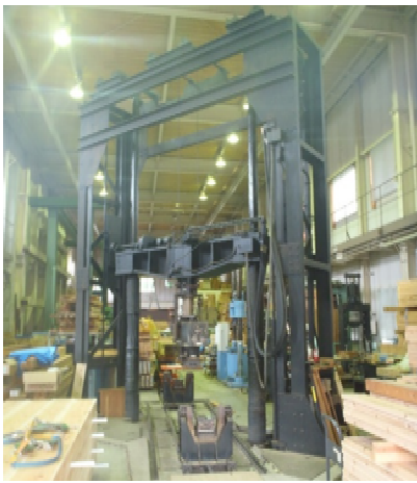
写真 - 3 実大曲げ試験機
