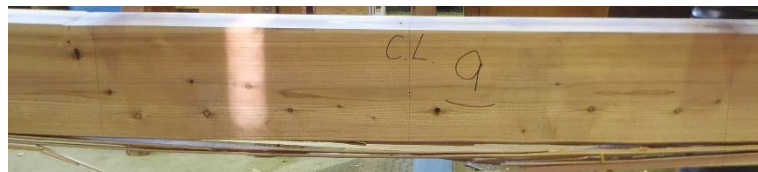
目視等級 3 級の試験体 (破壊試験後)
