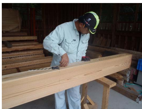
写真 - 2 欠点調査状況
