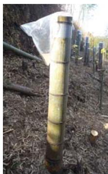
写真 - 1 竹水採取装置
