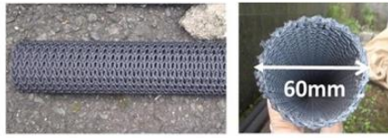
写真1 試験に使用した暗渠管（全面開孔型）
