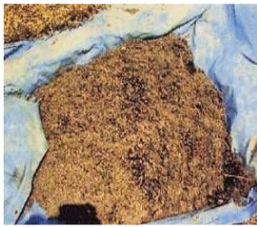
△ 腐食した疎水材（もみがら）
