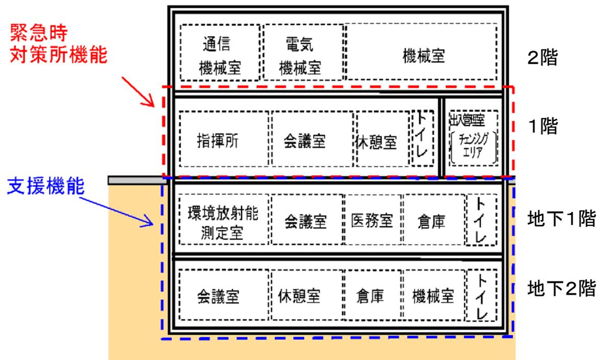
緊急時対策棟(断面図)
