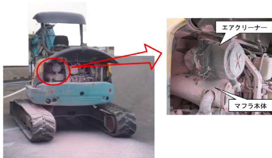
＜火災が発生した建設機械＞
