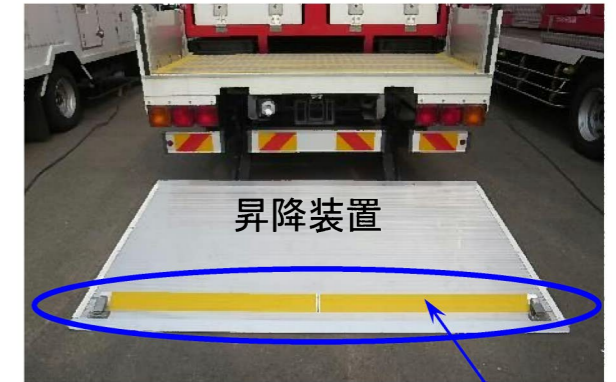
ストッパー部の段差にテープにて色付け表示
