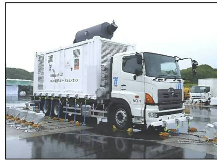
チェーンによる固縛 【川内の例】
