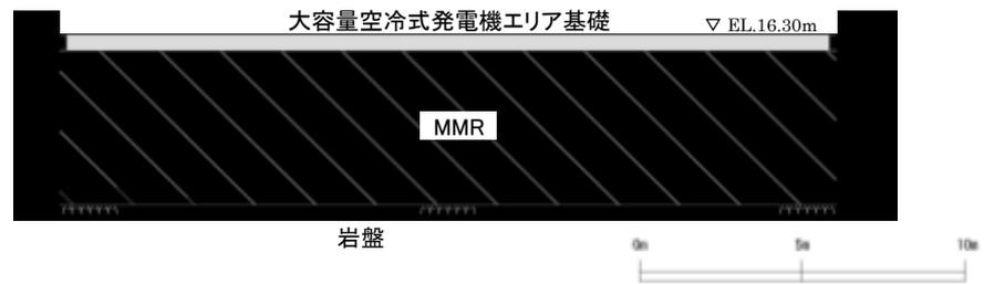
大容量空冷式発電機エリア基礎断面図
