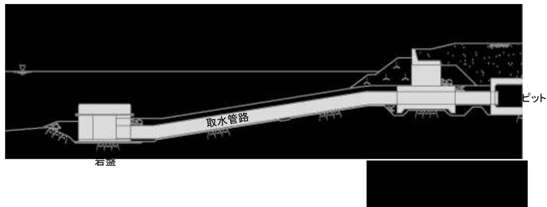
取水口及び取水管路断面図
