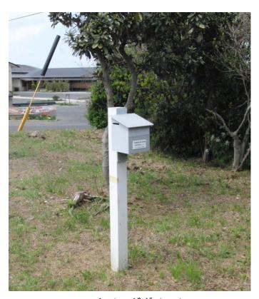
**モニタリングポイント**▶ 積算線量計を地上から1mの地点に設置
