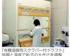
「有機溶媒用スクラパー付ドラフト」 時間と温度で粒子の大きさを調整
