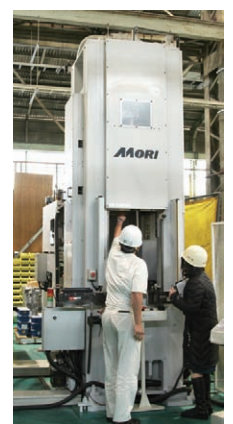
エコタイプ200トン6軸サーボ制御プレスは、ビット工事不要で床置きできる
