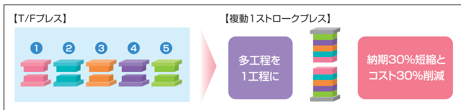
5工程をワンショットで成形した自動車部品
