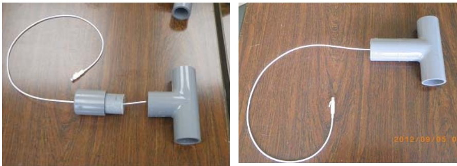
第 31 図 接続前の状況 (左) と完成したセンサー組み込んだ チーズ (右)
