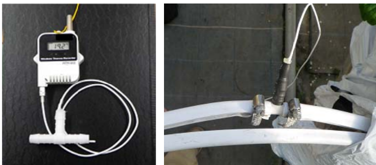
第 32 図 センサをはめ込んだチーズ(左)とチューブに接続した状況(右)
