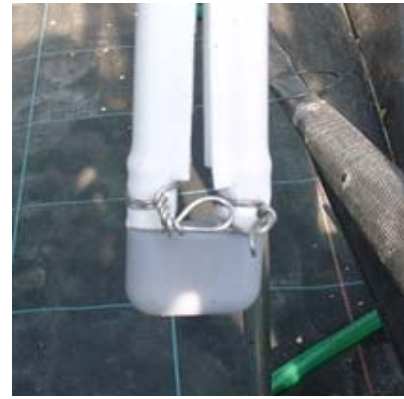
第16図 ベット反対側のU字管の接続状況
