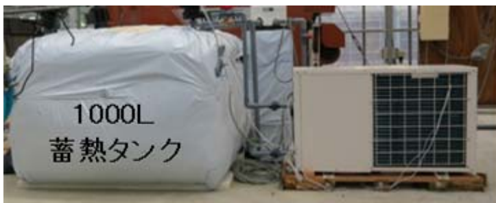
第17図 ポリタンク利用の蓄熱タンク
