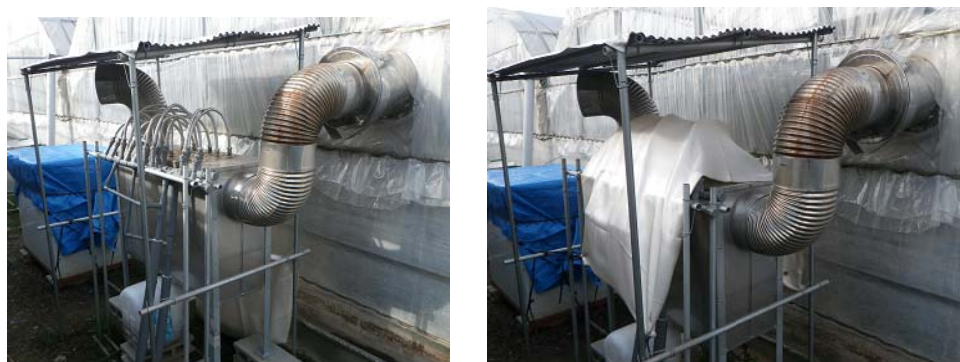
第 22 図 現地試験で設置した排熱回収器（右がフレキ管を耐熱シートで被覆し運転中） 注）M社箱型の排熱回収器は、コイル状のフレキ管が 6 セット入っています。
