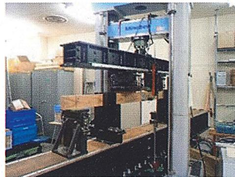
（製材段階での曲げヤング及び曲げ強度測定）
