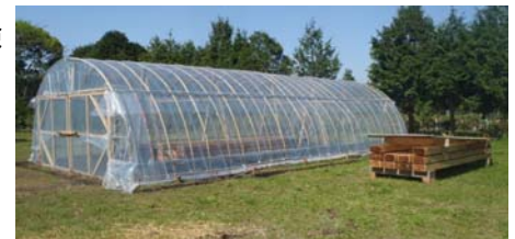
写真-2 天然乾燥状況
