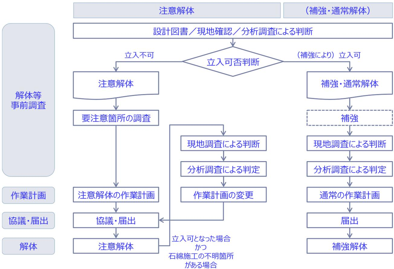
図 災害時に解体等工事を行う場合のフロー
