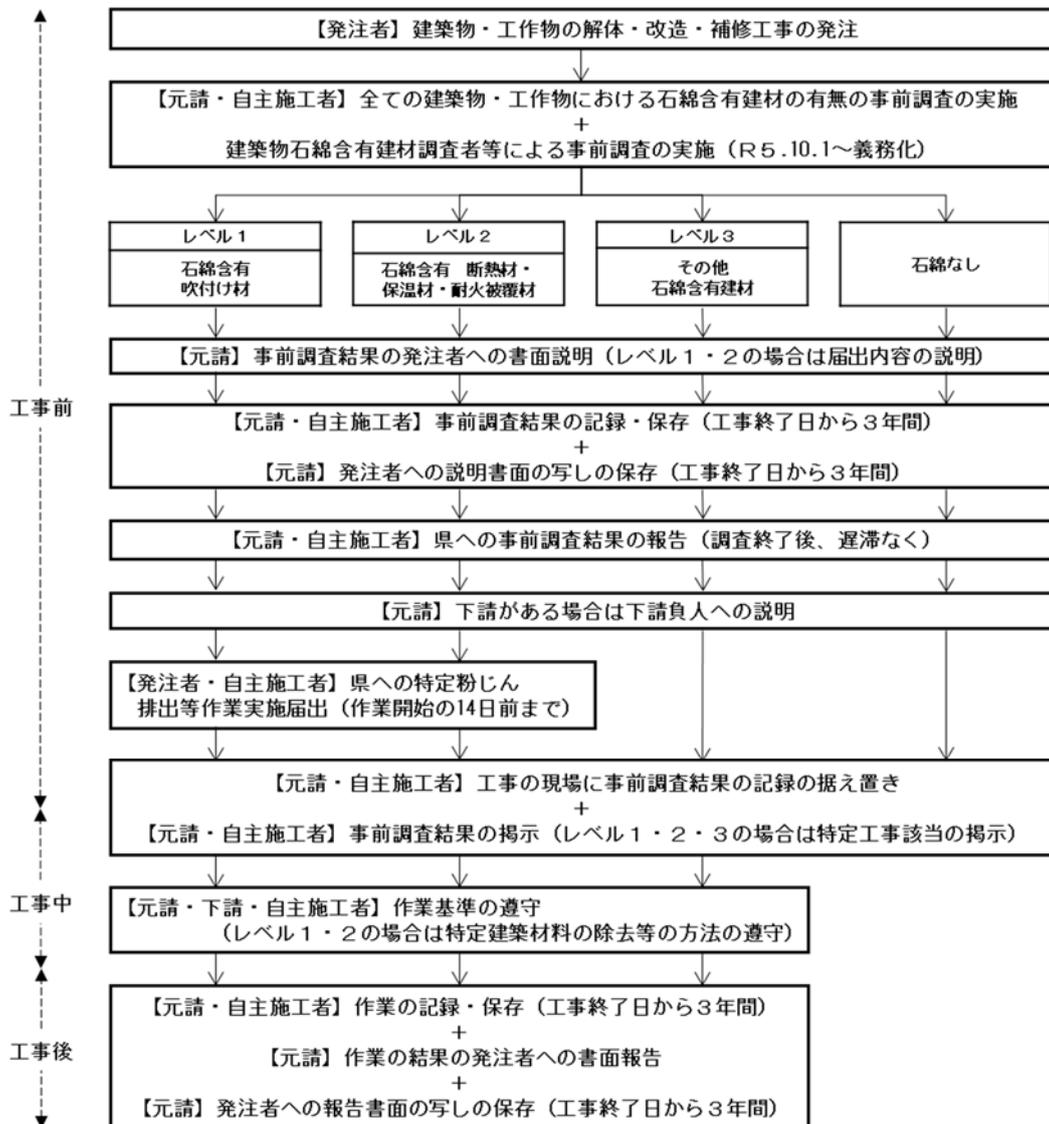
図1 建築物・工作物の解体・改造・補修工事における大気汚染防止法の規制の概要
