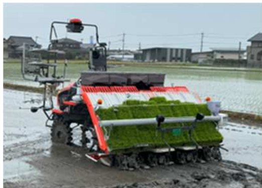
ロボット田植機による 無人での移植作業
