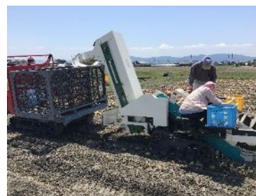
大型鉄製コンテナに対応した収穫機械
