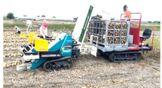
大型鉄コンテナ対応型の昇降機付きピッカーの導入
