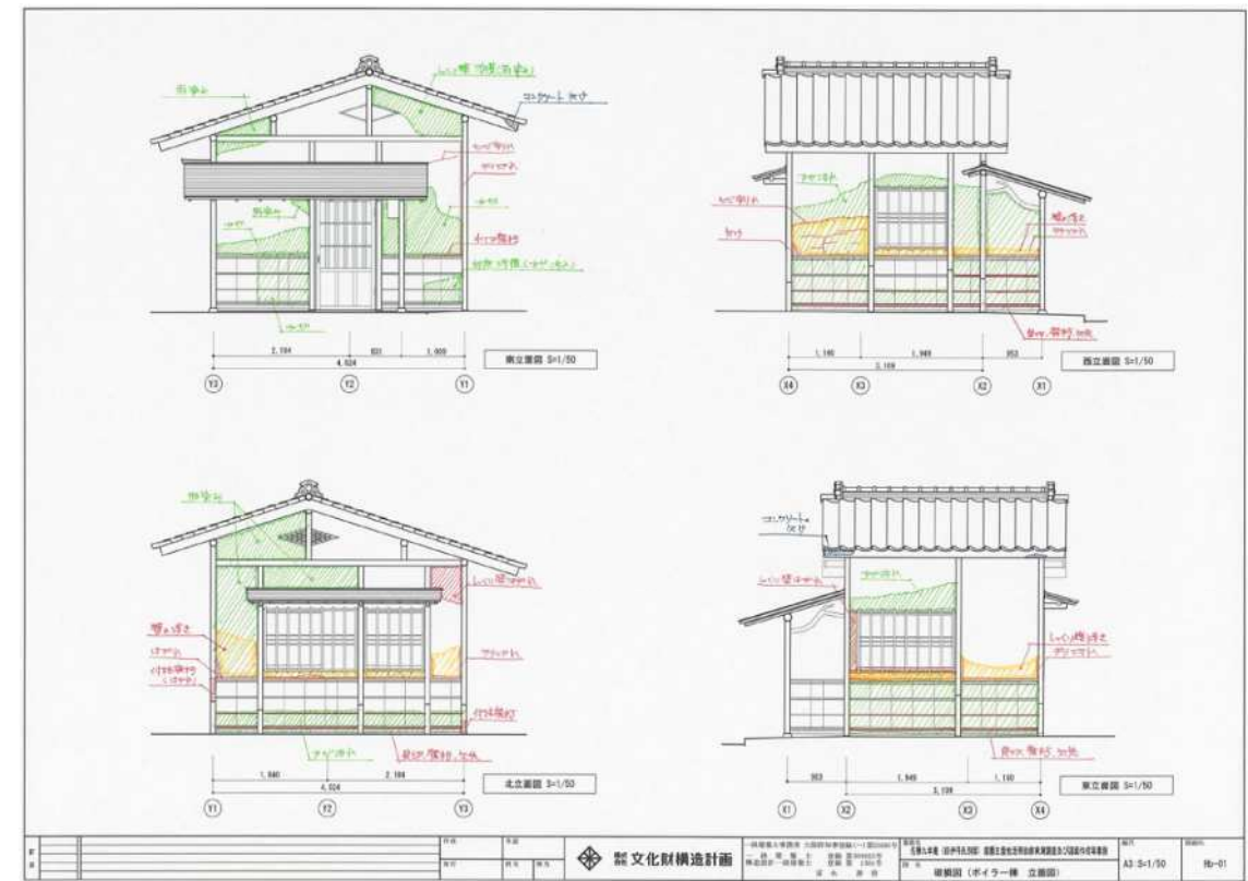
破損図（ボイラー棟）
