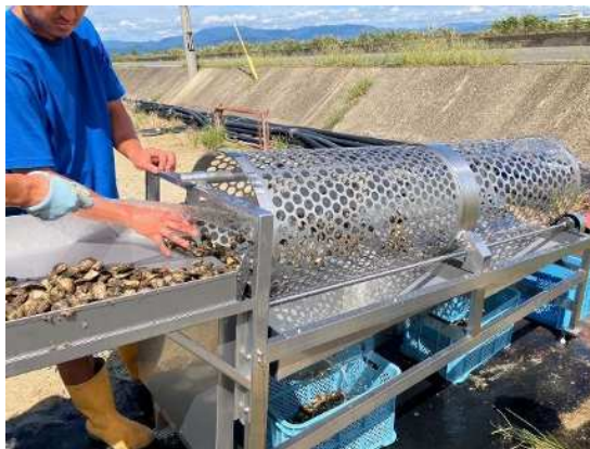
写真1 形状選別機を使用した作業の様子
