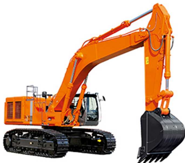
バックホウ: 土の掘削に使用
