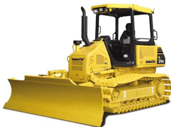
ブルドーザー: 土の押土に使用
