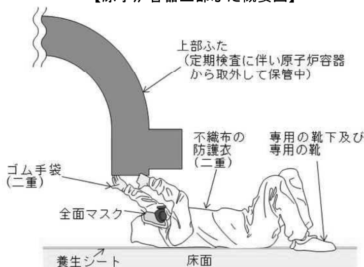
【原子炉容器上部ふたの手入れ作業】
