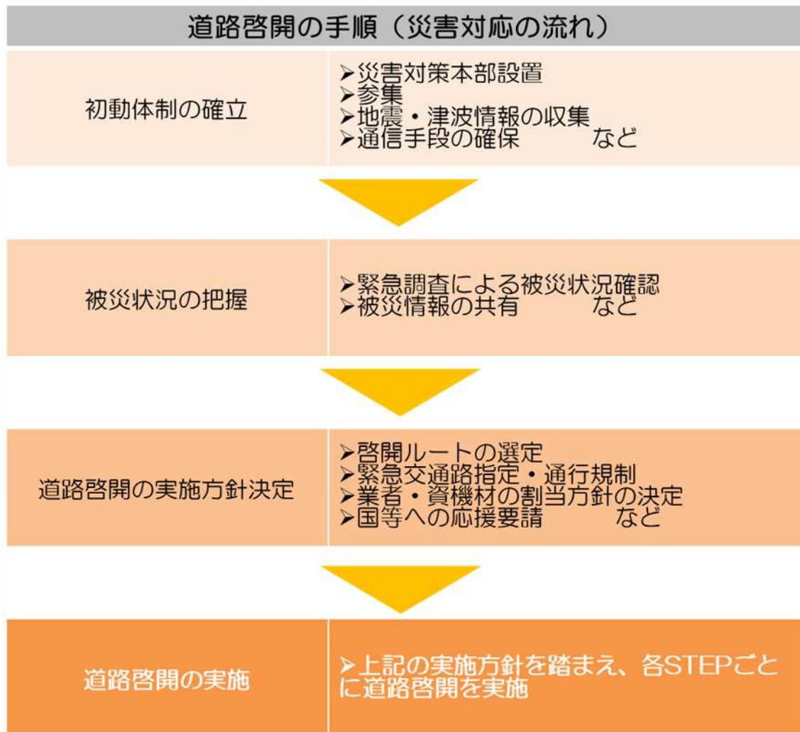
図 5-1 道路啓開の手順（災害対応の流れ）
