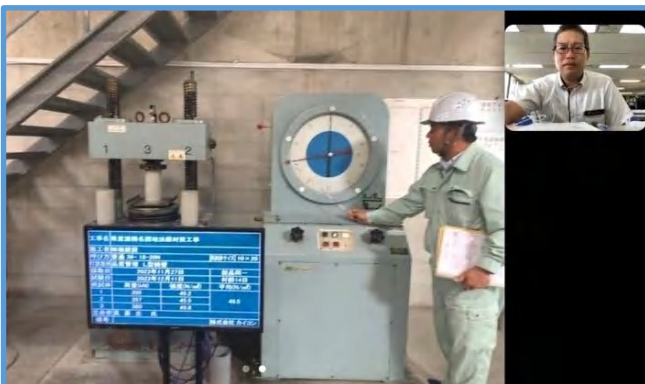
【圧縮強度試験 立会状況（工場側）】
