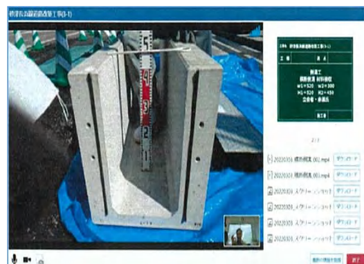
【横断側溝材料検収】
