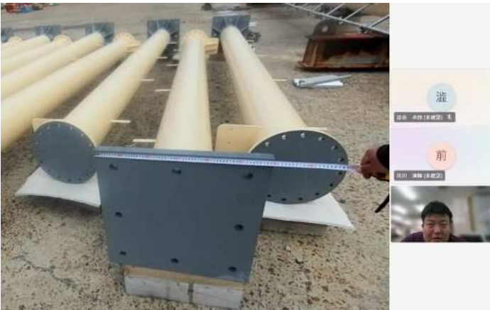
【出来形確認状況（遠景）】
