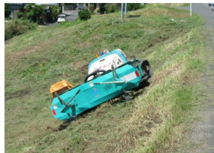
写真 4.3.2 遠隔操作による堤防除草作業
