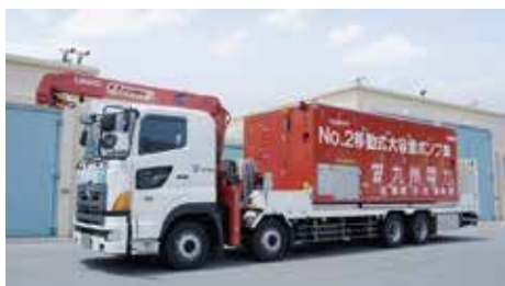
移動式大容量ポンプ車
