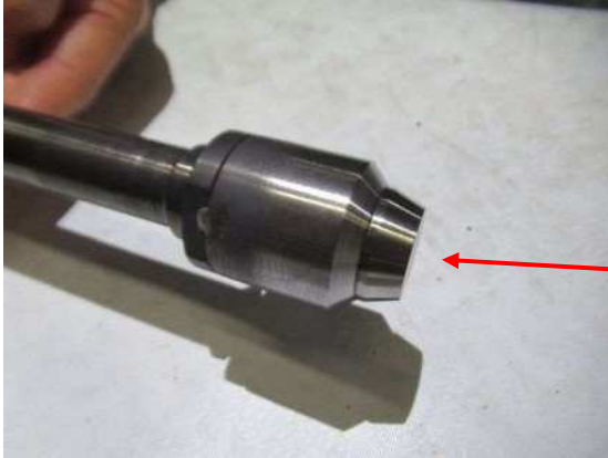
（１０）手入れ後の弁体（定検取替品）外観
