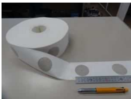
大気モニタ用紙（1か月毎に回収し Ge半導体検出器でγ線を測定）
