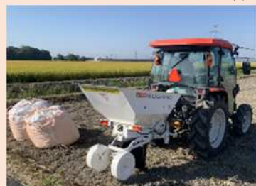
もみ殻暗渠埋没機による排水対策
