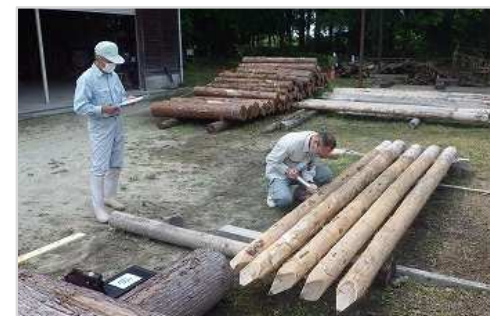
ピロディン調査状況
